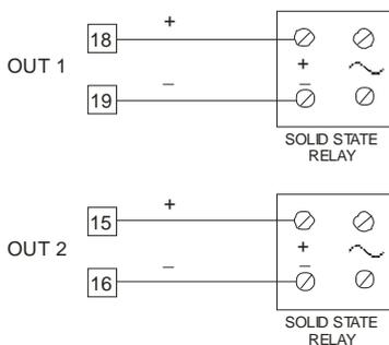
Fig. 11 SSR DRIVE OUTPUT WIRING
