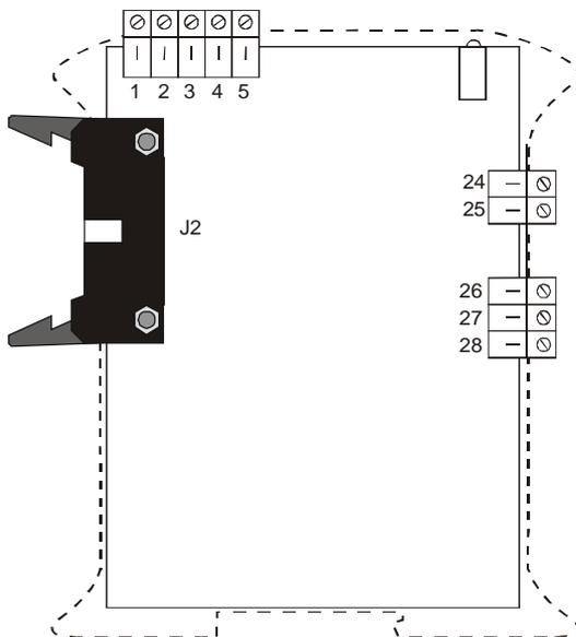
**Fig. 16 - COMMON I/O UNIT TERMINAL
