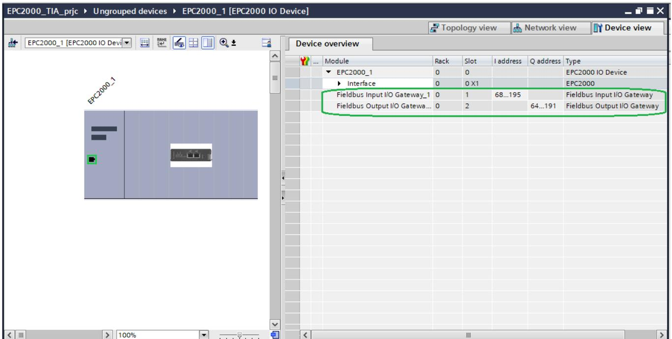
Nachdem Sie die Einstellungen für den zyklischen (E/A-Daten) Datenaustausch und das Fieldbus Gateway mit dem Konfigurationstool konfiguriert haben, müssen Sie die Konfiguration kompilieren und an die PROFINET-E/A-Steuerung (SPS) des PROFINET-Netzwerks herunterladen.
