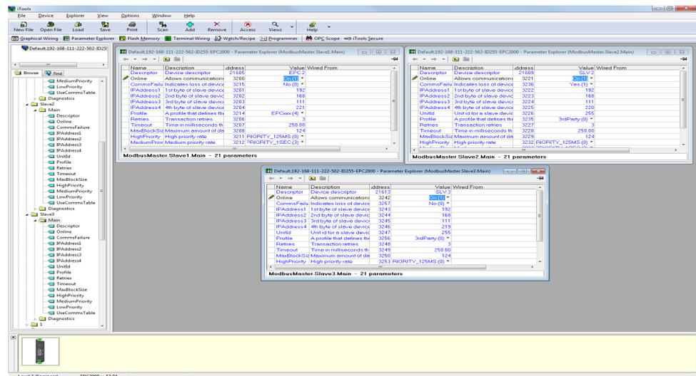
Der Datenlese- und Schreibstatus sollte erfolgreich sein, wenn die Verkabelung, die Kommunikationskonfiguration, die Slave-Konfiguration und die Datenkonfiguration korrekt sind. Die Anzeige der PV wird im Parameter Data PV angezeigt.
