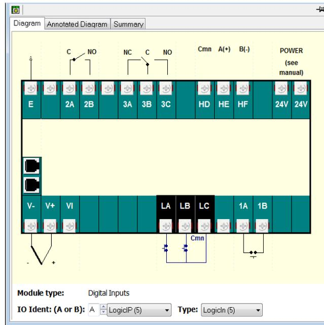
Klicken Sie in der daraufhin erscheinenden Ansicht auf einen Satz Klemmen, die ein EA-Modul darstellen. Wählen Sie den E/A-Typ aus der „IO Ident“-Drop-down-Liste aus. Daraufhin wird das Diagramm des gewählten EA-Typen passend zum gewählten Klemmensatz angezeigt.
