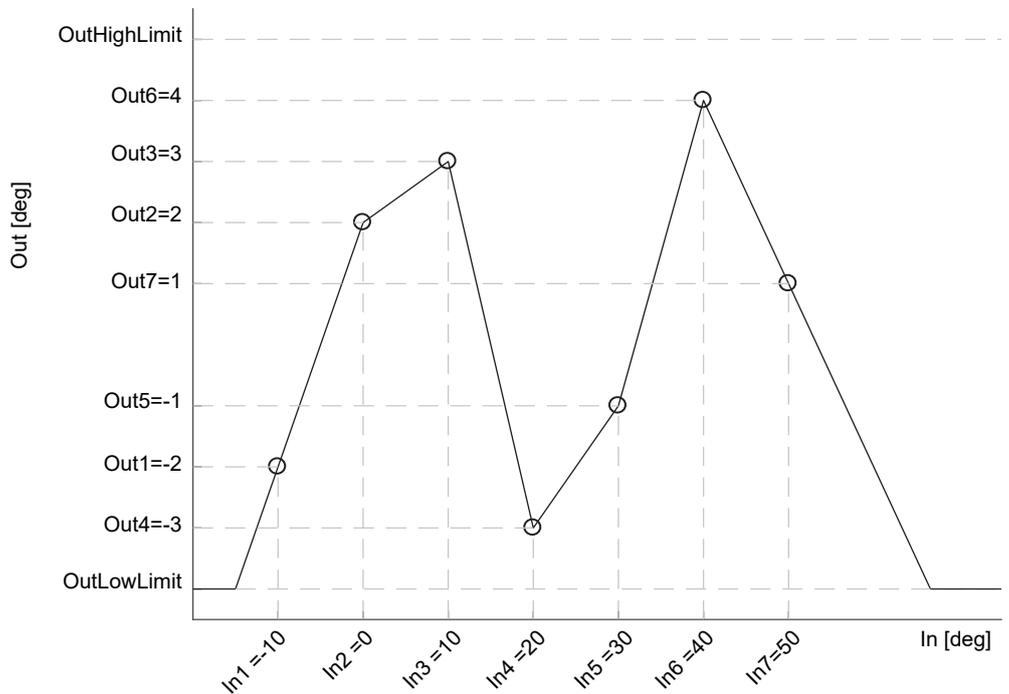
Beide oben aufgeführten Konfigurationen stellen dem Regelkreis-Funktionsblock die gleiche bereinigte PV bereit. Die Werte sind für die beiden Beispiele in der Tabelle aufgeführt. Die hohen Werte der Offsets dienen in den Abbildungen nur dazu, die Aktion der Anpassung zu akzentuieren.
