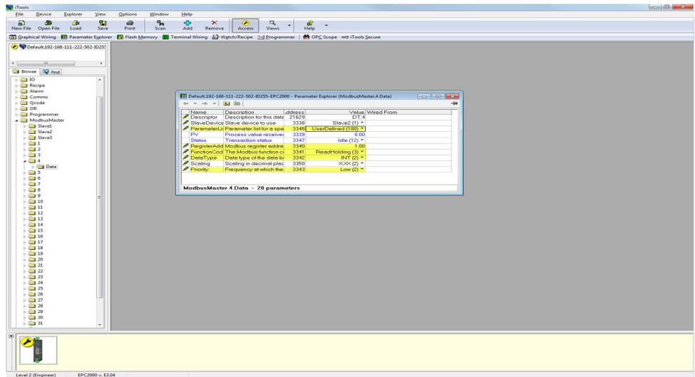
4. Zum Starten der zyklischen Kommunikation mit den Slaves: Nehmen Sie das Modbus Master-Gerät aus dem Konfigurationsmodus und stellen Sie den Onlineparameter für jeden der Slaves ein.
