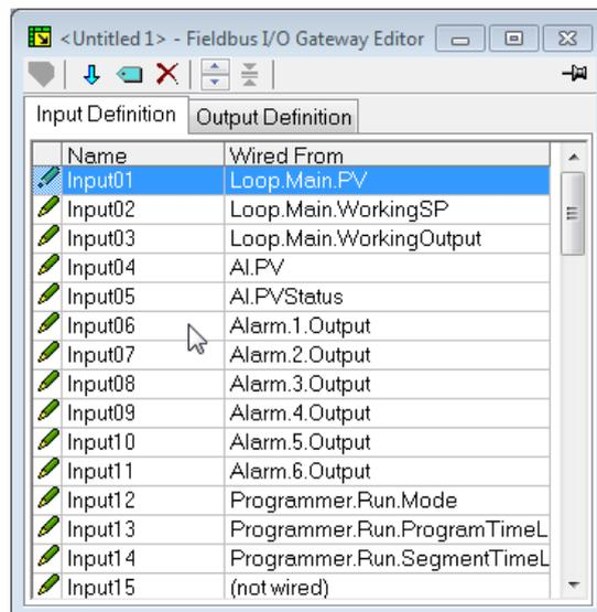
Per Systemvorgabe sind die Eingangs- und Ausgangstabelle mit den am häufigsten verwendeten Parametern konfiguriert.
