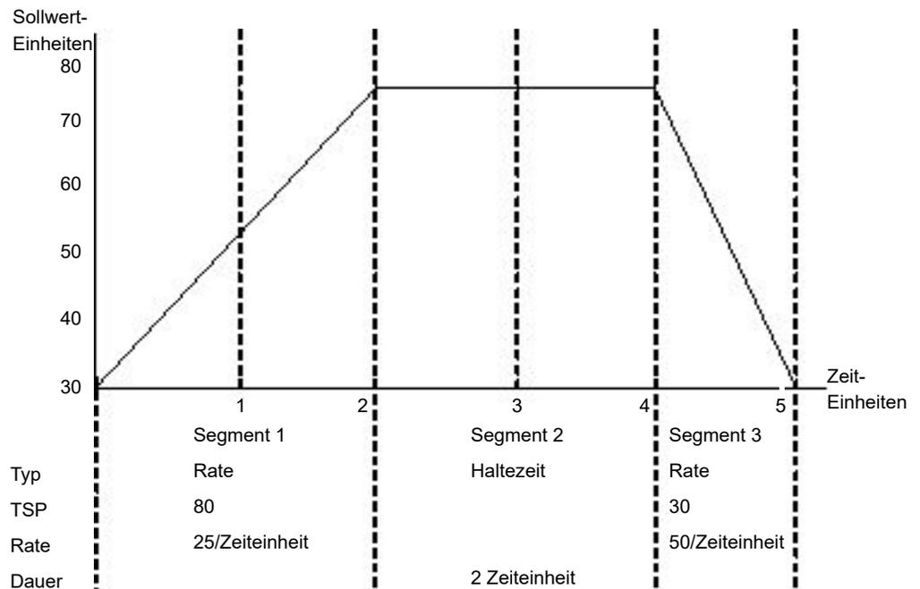
Im Beispiel oben ist ein einfaches, aus drei Segmenten bestehendes Programm zu sehen, bei dem der Zielsollwert (TSP) mit einer kontrollierten Geschwindigkeit von 25/Zeiteinheiten auf einen Wert von 75 steigt. Er wird dann zwei Zeiteinheiten lang auf diesem Sollwert gehalten, bevor er mit einer kontrollierten Geschwindigkeit von 50/Zeiteinheiten auf 30 absinkt.
