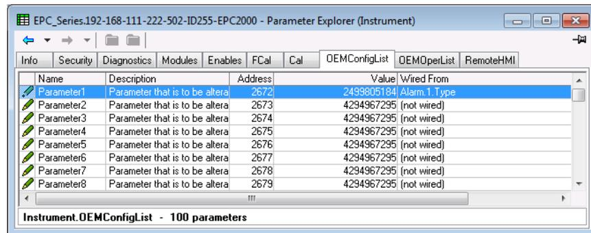
Die Ansicht zeigt die ersten acht Parameter, von denen Parameter 1 mit einem Konfigurationsparameter belegt wurde (Alarm 1 Typ). Beispiele für Konfigurationsparameter sind Alarmtypen, Eingangsarten, Bereich Hoch/Tief etc.
