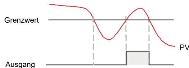
Die Alarmunterdrückung wird je nach Alarmspeicherungsstatus nach dem Aus- und Wiedereinschalten bzw. nach dem Verlassen der Konfiguration wie folgt erzwungen:
