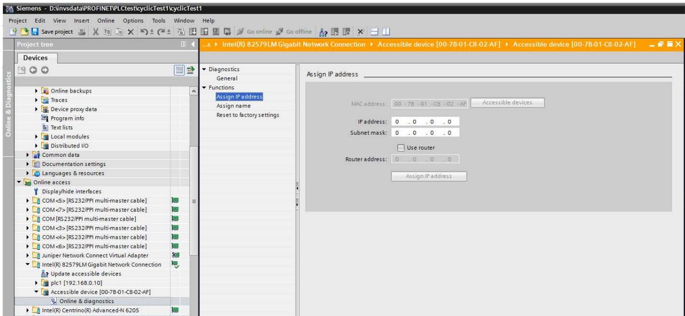
**Anmerkung:** Das Standard-Gateway kann auf die gleiche Weise geändert werden (in diesem Beispiel mit „Router address“ bezeichnet).
