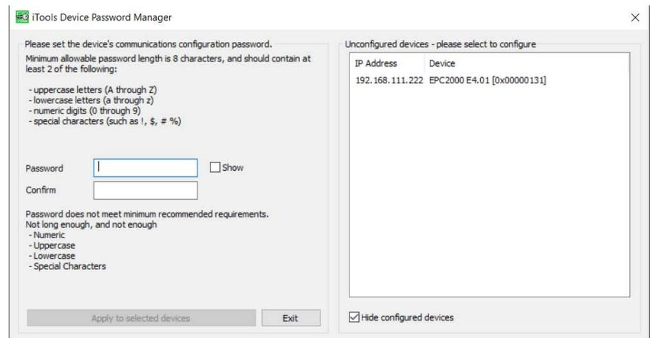
12. Anschließend stellt der programmierbare Regler EPC2000 eine Verbindung zum Gerät im Konfigurationsmodus her und die folgenden Punkte erscheinen:
