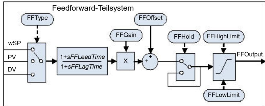
Der Regelkreis enthält neben dem normalen Feedback-Regler (PID) auch einen Feedforward-Regler, der sowohl statische als auch dynamische Feedforward-Kompensation ermöglicht. Es gibt, grob betrachtet, drei gebräuchliche Anwendungen für Feedforward in diesen Geräten. Diese werden im Folgenden beschrieben.
