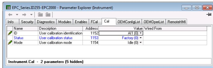
Als Statusparameter wird dort „Factory“ angezeigt, sofern Sie zuvor noch keine Kalibrierung durchgeführt haben.
