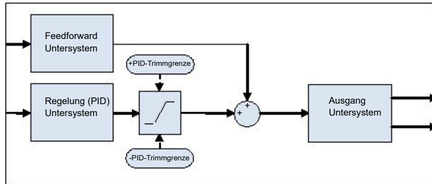
Um die PID-Komponente herum wird ein symmetrischer Trimbereich gebildet, wodurch der Einfluss des Feedback Trimms begrenzt bleibt.
