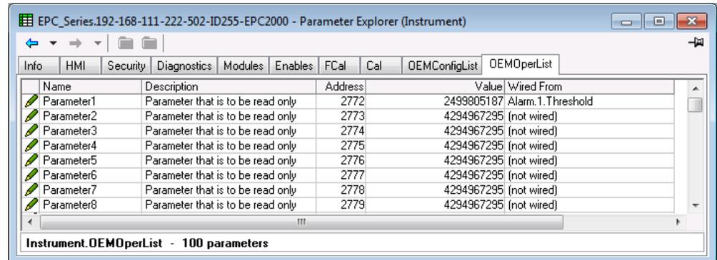
Das Beispiel zeigt die ersten 8 von 100 Parametern, von denen der erste als „Alarm 1 Threshold“ ausgewählt wurde. Dieser Parameter ist bei aktivierter OEM-Sicherheit schreibgeschützt, wenn der Regler sich im Bedienmodus befindet.
