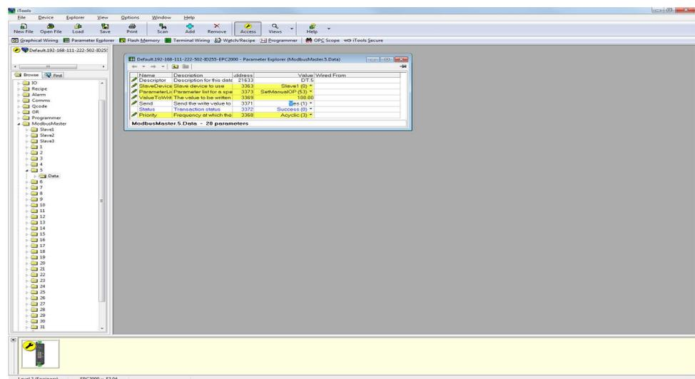
3. Um die Schreibanfrage zu senden, setzen Sie den „Send“-Parameter (Senden). Der Status lautet jetzt zunächst kurz „Pending(13)“
