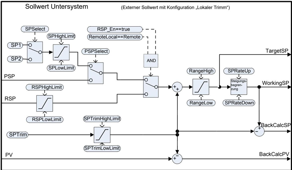
Im zweiten Diagramm wird ein Sollwert-Untersystem mit der Konfiguration „Lokaler Sollwert mit externem Trimm“ gezeigt.
