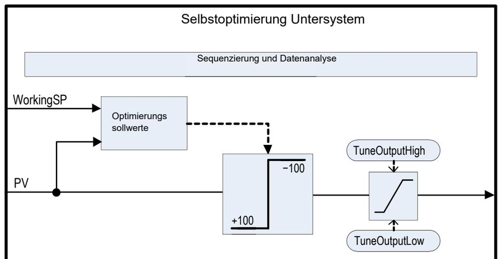
Der Funktionsblock enthält ausgereifte Selbstoptimierungsalgorithmen, mit denen der Regler exakt auf den Prozess eingestellt werden kann. Diese Algorithmen führen an der Anlage Tests durch, lösen Störungen aus und beobachten und analysieren die Reaktionen darauf. Die Selbstoptimierungssequenz finden Sie im Folgenden ausführlich beschrieben.
