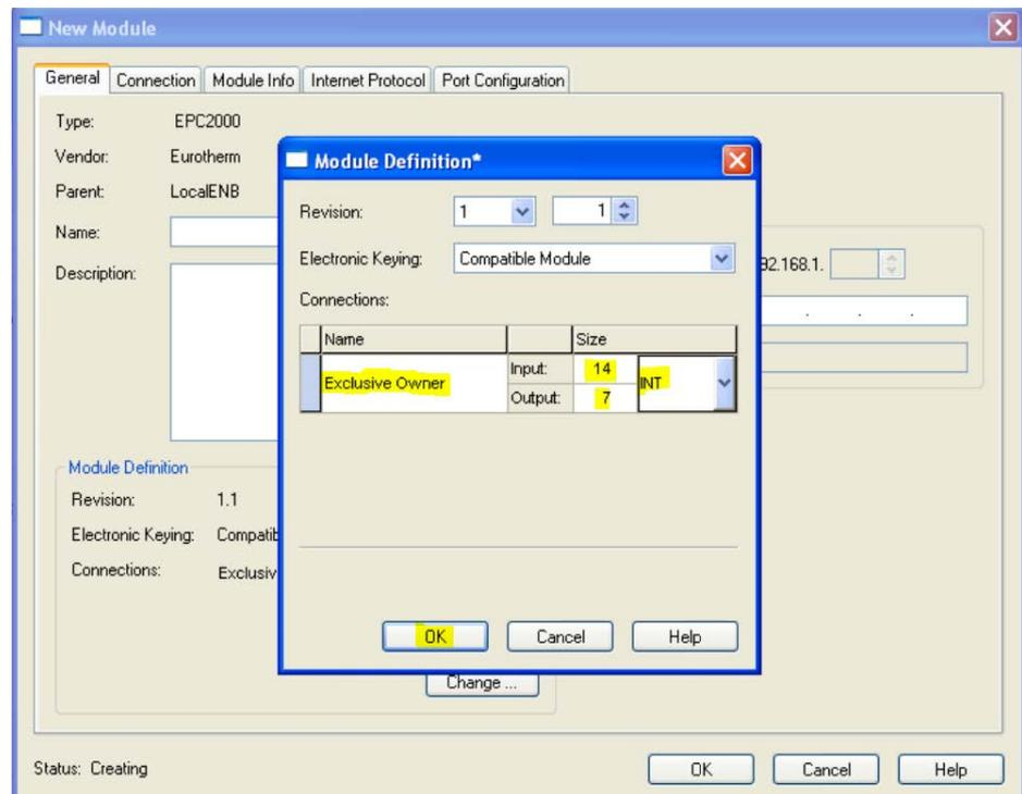
4. Im Fenster „New Module“ (Neues Modul) konfigurieren Sie die IP-Adresse des EPC2000 EtherNet/IP-Adapters. Geben Sie einen sinnvollen Namen ein und klicken auf OK.
