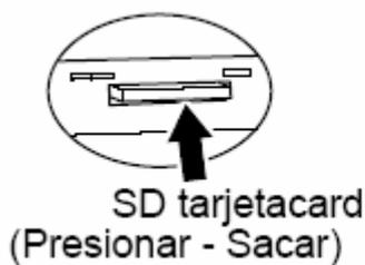
Figura 2.3.2 a Detalles tarjeta SD
