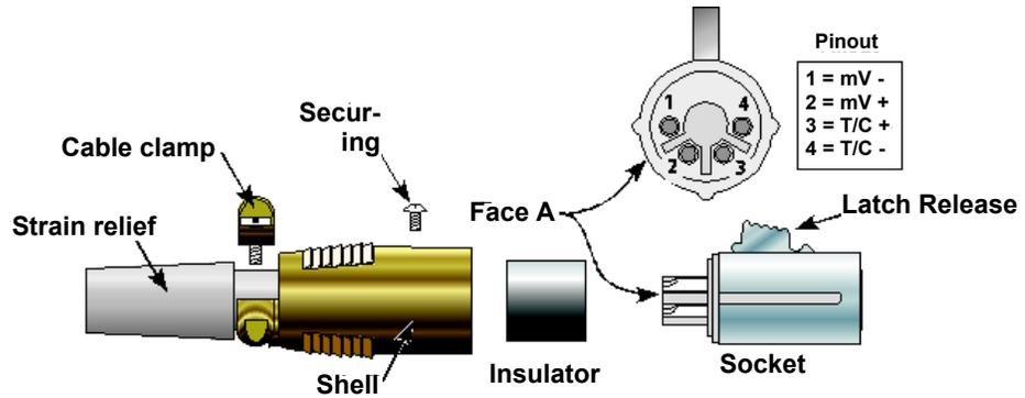
Figure 3 DIN Plug Wiring
