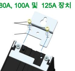
벌크헤드 장착 시, 'B' 나사와 연관된 흔들림 방지 와셔를 제거한 후 브래킷을 장치에 끼워넣은 다음 'B' 나사를 이용하여 체결하여 상단 브래킷 'A'를 장치의 후면에 설치합니다. 체결 시 브래킷이 올바른 방향으로 되어 있는지 확인하세요. (깃처럼) 흔들림 방지 와셔가 나사 헤드와 브래킷 사이에 끼워져 있어야 합니다. 연관된 스크루 드라이버에는 3mm AF 6각형 비트가 있어야 합니다. 권장된 체결 토크는 1.5Nm (1.1 lb-ft)입니다.
