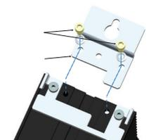
对于隔板安装，通过卸下螺丝“B”和相关的防震垫圈将上支架“A”安装到设备后部，将支架安装到设备上，然后使用螺钉“B”将其固定，确保支架的方向正确（如图所示）并且防震垫圈安装在螺钉头和支架之间。
