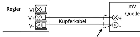
Abbildung 1: Anschlüsse für die mV Eingang Kalibrierung
