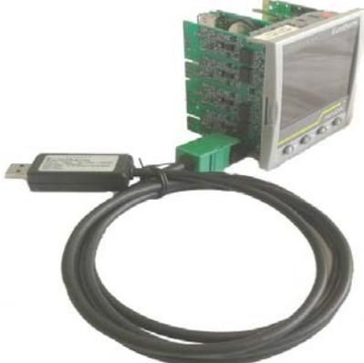
Der Vorteil dieser Verbindung liegt darin, dass das Gerät nicht angeschlossen sein muss, da der Clip die Versorgung für den internen Speicher des Reglers liefert.
