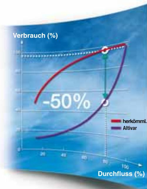
Bei Ansteuerung durch einen Frequenzumrichter liegt die Motorleistung bei 80% des Bemessungsflusses bei 50% der Bemessungsleistung. Bei herkömmlicher Ansteuerung liegt sie hingegen bei 95% der Bemessungsleistung.
