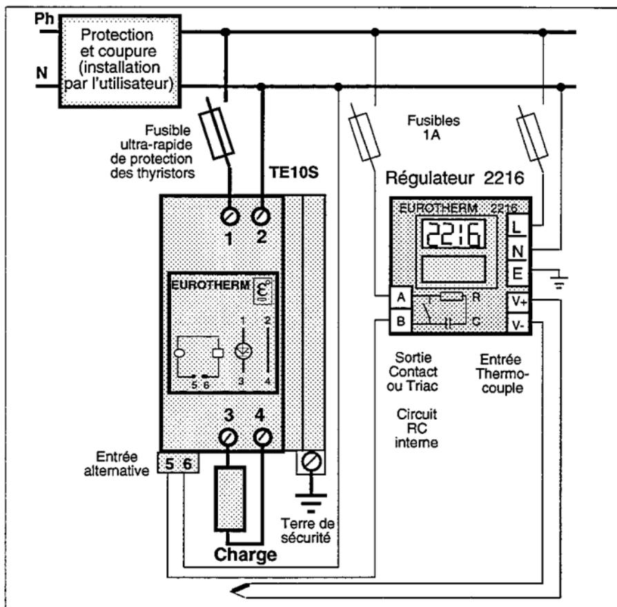
Exemple de branchement du TE10S (entrée alternative 200-240 V) contrôlé par le régulateur Eurotherm Série 2000
