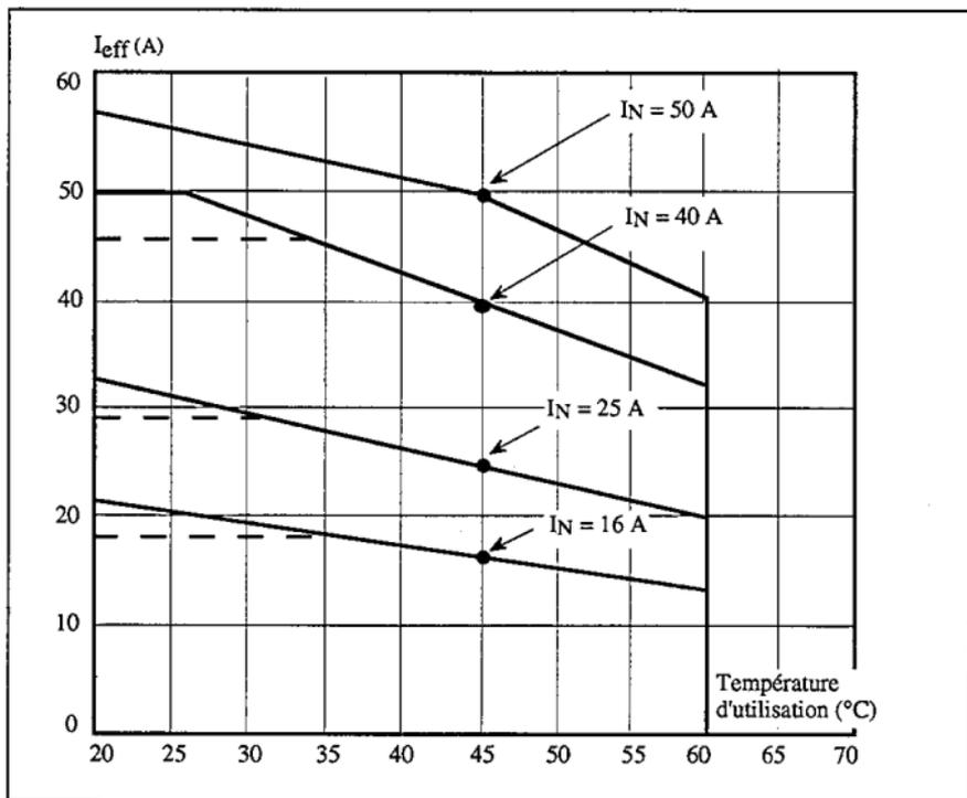
Courbes de courant maximum admissible en fonction de la température ambiante ( $I_N$  = courant nominal à  $45^{\circ}C$ )
