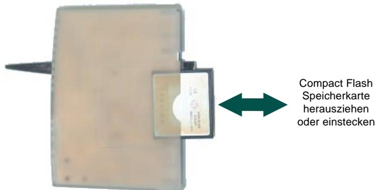
Abbildung 8.2.1 Austausch der Compact Flash Speicherkarte
