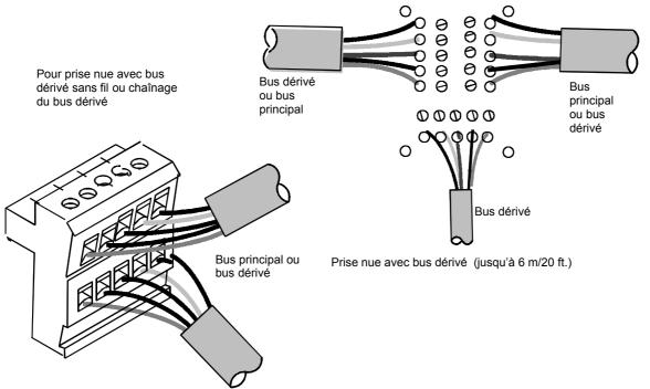
Ce type de prise est généralement utilisé à l'intérieur d'une armoire de commande afin de connecter une unité au bus principal.
