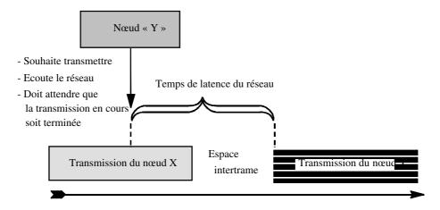
Si deux nœuds ou plus commencent à transmettre en même temps, le conflit est résolu par un algorithme d'arbitrage non destructif par comparaison bit à bit à l'aide du champ Arbitrage.
