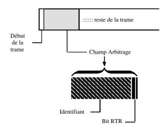
Le champ Identifiant à 11 bits est transmis du bit le plus significatif au bit le moins significatif.
