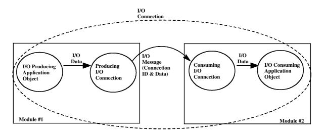
Les spécifications ne définissent pas d'utilisation particulière pour la messagerie d'E/S. Une grande variété de fonctions peut être exécutée à l'aide de la messagerie d'E/S. En raison du type particulier de produit qui émet un message d'E/S, ou en fonction de la configuration exécutée à l'aide de la messagerie explicite, la signification et/ou l'utilisation prévue de tous les messages d'E/S peut être connue du système.
