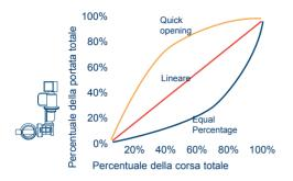
Le caratteristiche di apertura rapida e di ugual percentuale di flusso della valvola sono compensate automaticamente dalla linearizzazione dell'uscita Questa funzione linearizza il rapporto tra il flusso e la corsa della valvola per ottenere un miglior controllo del processo.
