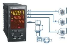
La percentuale dell'uscita di controllo è monitorata da un allarme di processo configurabile: in questo modo si semplifica il controllo del processo. Nell'esempio riportato lo strumento controlla un processo tramite una valvola di portata d'aria. Il generatore della portata d'aria utilizza 3 ventilatori di cui il primo è sempre attivo, mentre gli altri due vengono attivati quando la potenza dell'uscita raggiunge il valore programmato [33 % (AL 1) e 66% (AL 2)].
