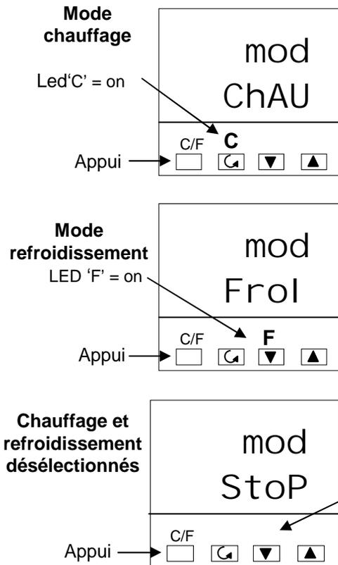
Appuyer sur ▲ ou ▼ pour sélectionner un nouveau mode de régulation. L'afficheur inférieur se mettra à clignoter. Appuyer sur la touché C/F pour accepter le nouveau mode.
