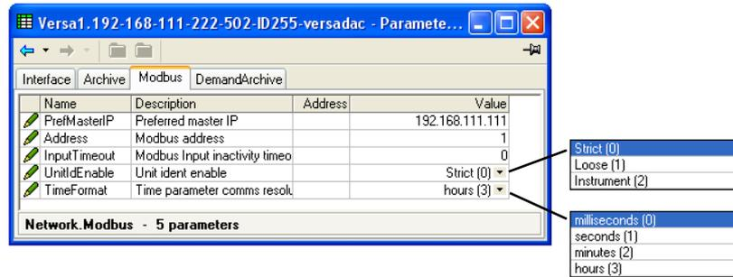
Figure 4.2.3 Menu de configuration Modbus TCP
