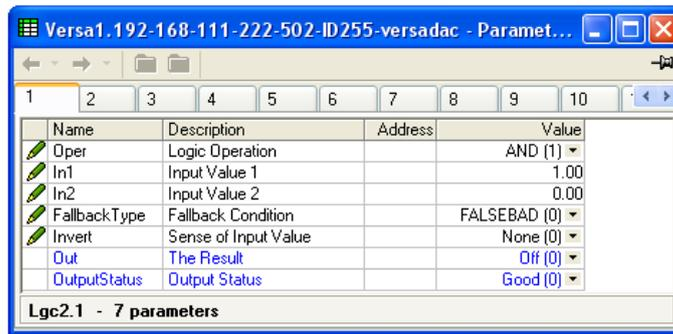
Figure 4.14 Configuration d'un bloc logique à deux entrées
