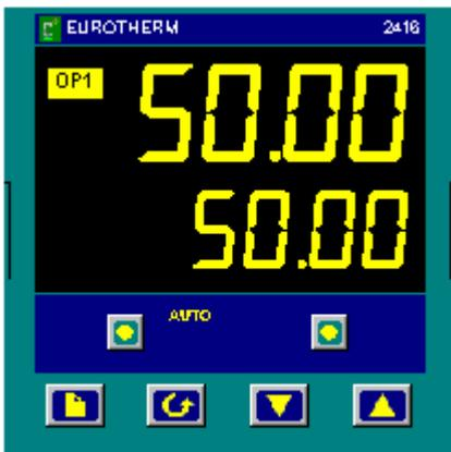
Die Bedienfläche zeigt die Gerätefront eines Serie 2000 Reglers. Über diese Darstellung können Sie mit einem realen oder simulierten Gerät über die Replik der Bedientasten und der Anzeige der 'Live' Daten kommunizieren.
