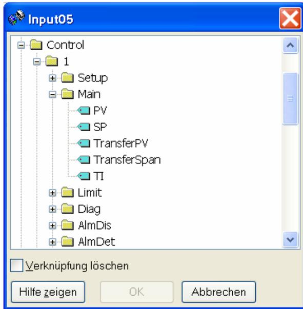
Haben Sie alle benötigten Parameter hinzugefügt, sollten Sie sich notieren, wie viele Verknüpfungen Sie in den Ein- und Ausgangs Definitionen gelegt haben, da diese Information für das Aufsetzen des Profibus Masters notwendig ist.
