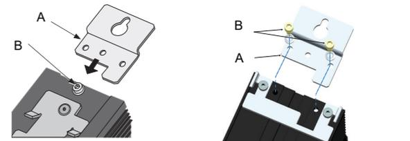
Pour le montage en fond d'armoire, placer la fixation supérieure 'A' à l'arrière du gradateur en retirant la vis 'B' et sa rondelle antivibrations, en présentant la fixation à l'appareil, puis en la fixant au moyen de la vis 'B', en s'assurant que la fixation est correctement orientée (comme indiqué) et que la rondelle antivibrations est installée entre la tête de vis et la fixation.
