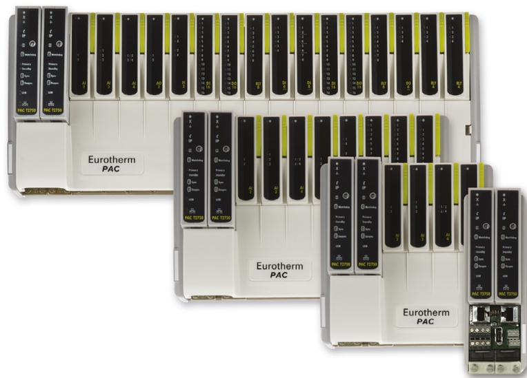
Il T2750 è un sistema modulare per il controllo PID multi-loop, con I/O analogici e digitali, condizionamento dei segnali e blocchi di calcolo che utilizza diversi moduli plug-in.
