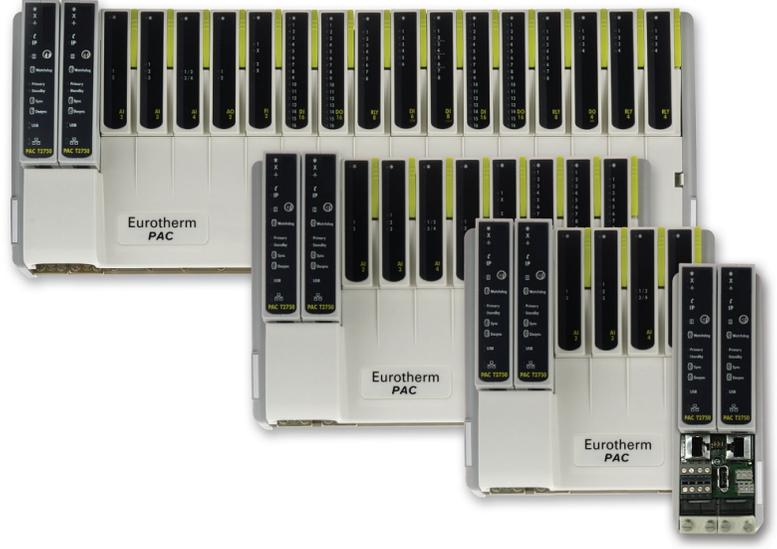
T2750是一个借助多个插件模块, 提供多回路PID控制、模拟和数字量输入/输出、信号调和计算的模块化系统。设备由一个基座单元组成, 其中安装有一系列的端子板, 每个端子板上插有一个关联的模块。基座单元配备有一个或两个输入/输出控制器 (IOC) 模块和多达16个输入或输出 (I/O) 模块。IOC模块包括系统配置和通信支持。一体式SD卡包含策略和数据库信息, 所以在有必要更换IOC时可以直接将SD卡从旧模块移动到待装配的新模块, 这样可以最小化对系统的干扰。各模块有专用的端子板, 其上提供有用户连线用的端子接头。端子板也提供各输入/输出模块和IOC模块之间的互联。夹在端子板内的输入/输出模块, 设计专用于模拟和数字量输入和输出。DINPSU即是一种合适的电源, 有1.3、2.1、5.0或10.0安培的单元。关于能量消耗方面的数据请参考用户手册 (HA030047)。
