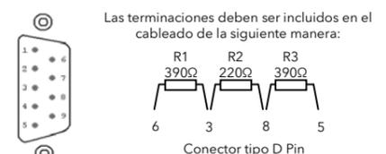
Para terminación de tipo D, los resistores de 390 ohmios deben conectarse a través de los pines 3-6 y 4-8, y un resistor de 220 ohmios entre los pines 5 y 8..
