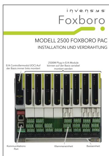
Das System 2500 ist ein intelligentes, dezentrales E/A System mit lokalen PID Regelblöcken. Es besteht aus einer Basiseinheit mit aufgesteckten Klemmeneinheiten. Auf diese wiederum werden die verschiedenen Regel- oder E/A Module aufgesteckt.
