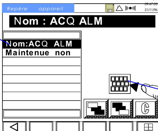
Appuyez sur la touche d'accès au clavier numérique pour écrire le nom. Entrez le nom 'ARR.ACQ' (pour ARRêt ACQuisition), appuyez sur pour fermer le clavier puis sur pour valider.
