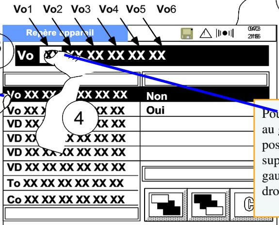
Pour ajouter une voie d'entrée au groupe, sélectionnez sa position dans la fenêtre supérieure (la voie 1(7) est à gauche, la voie 6(12) est à droite)
