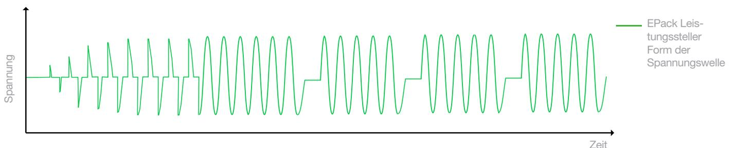
Der EPack-Leistungsregler schaltet in Abhängigkeit vom ohmschen Wert der Last automatisch vom Impulsgruppenbetrieb in den Phasenanschnittbetrieb um, z.B. während der thermischen Streßphase, wenn die Last also kalt ist. Die fortschrittliche Anlauffunktion ermöglicht einen sanften Anlauf mit geringerer Belastung der Last.
