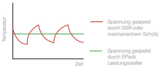
Im Vergleich zu einem Standard-SSR oder mechanischen Schütz passt der EPack-Leistungssteller die an das Heizelement gelieferte Energie an, wodurch Temperaturschwankungen reduziert werden und die Lebensdauer des Heizelements verlängert wird.
