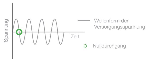
Der EPack-Leistungssteller kann einen Nulldurchgang auf der Spannungswellenform genau erkennen und ist in der Lage, den Thyristor in diesem Moment zu triggern. Dies führt zu weniger harmonischen Verzerrungen und RFI, zur Reduzierung der Gleichstromkomponente und zu einer präzisen Reaktion auf den Leistungsbedarf.
