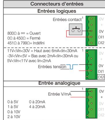
Entrée configurable par l'utilisateur 10.2V, 10mA max. Configurable en tant que sortie +10V pour potentiomètre externe
