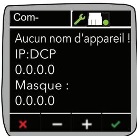
Figure 45 Écran « Comms » de l'EPack sortant de l'usine (Nom de l'appareil = « », Configuration IP = Nul).
