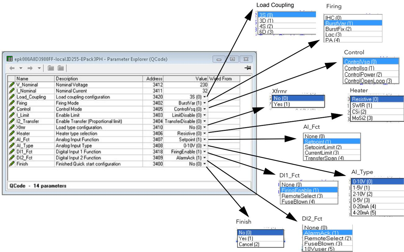
Figure 124 Quick code parameters
