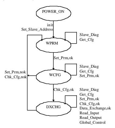
Quand le Système se trouve dans l'Etat DATA\_EXCHANGE\_STATE (DXCHG), les mesures de l'EMA peuvent être lues.
