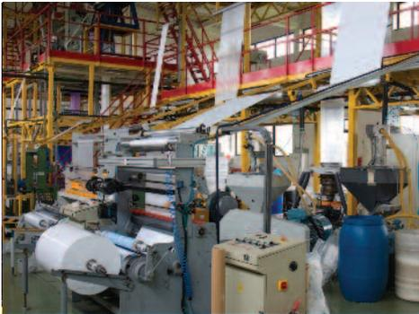
L'**extrusion plastique** est un procédé dans lequel du plastique brut est fondu et formé dans un profil continu, pour produire des objets tels que des tubes, des encadrements de fenêtres, des bandes et des isolants. Pour s'assurer qu'ils fonctionnent au maximum de leur efficacité et que la sécurité des opérateurs est maintenue au plus haut niveau, notre client souhaitait mettre à jour un certain nombre d'extrudeurs dans son usine.
