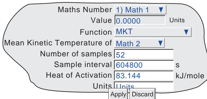
Figure 3.2.6 MKT function parameters
