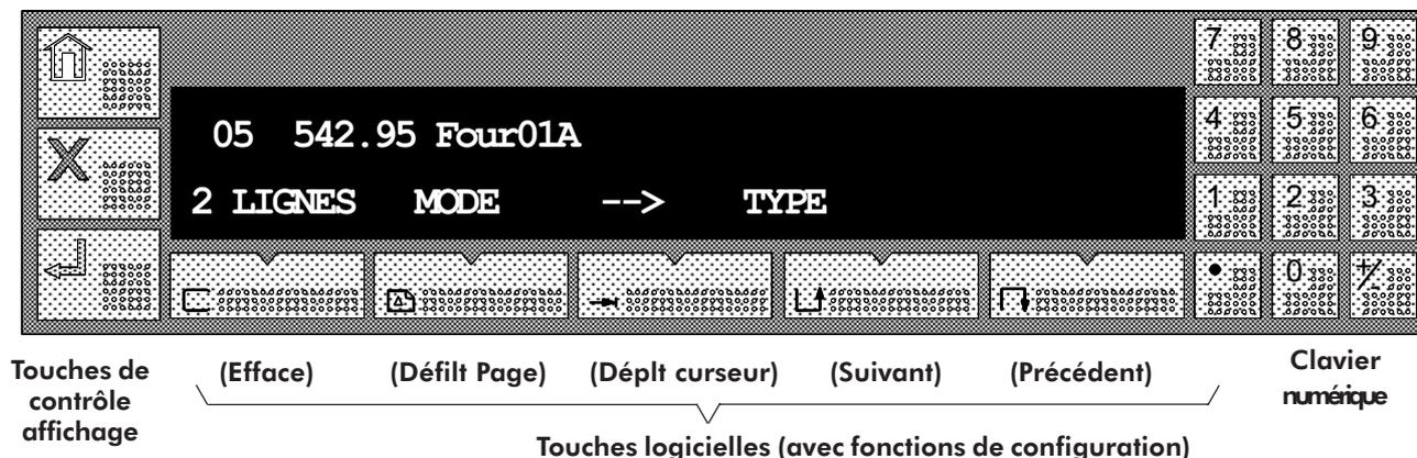
Figure 2.2 Afficheur / clavier
