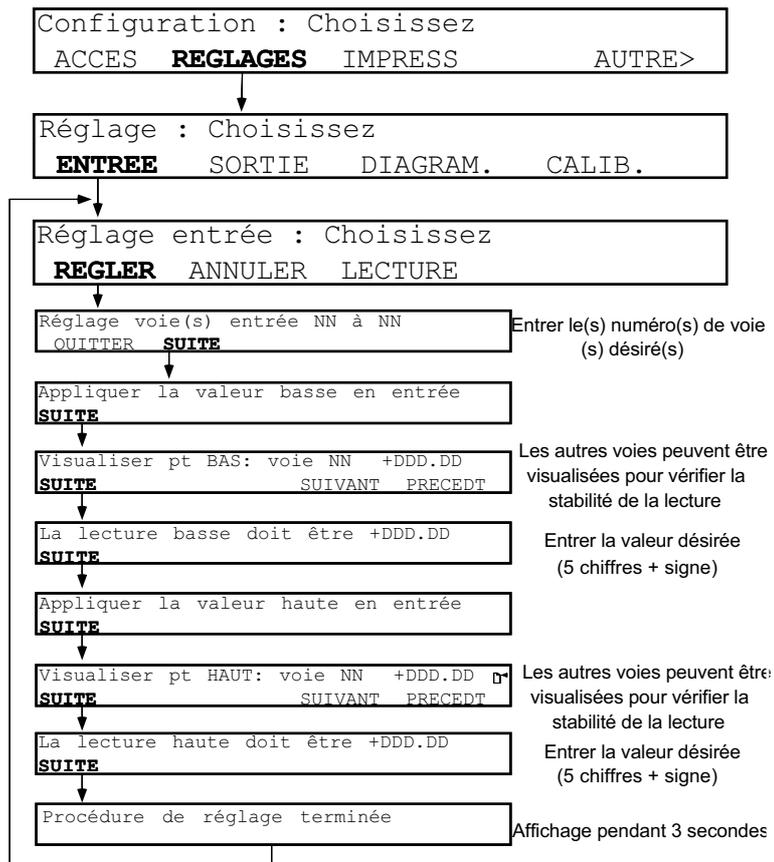
Figure 4.14.1 Menus de réglage de voies d'entrée
