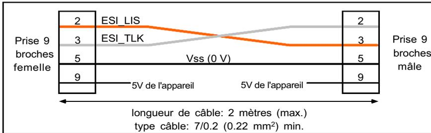
Figure 1.6a Spécifications du câble de transfert de configuration
