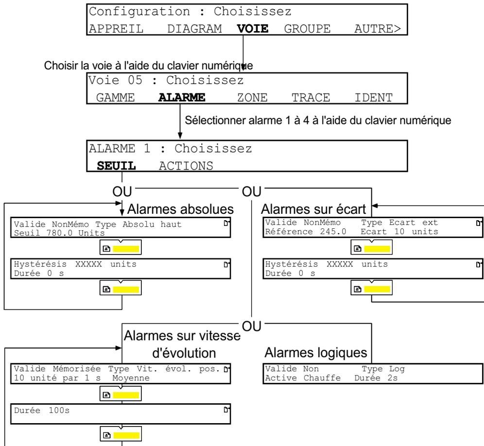
Figure 4.4.3d Configuration de voie: Pages typiques d'alarme
