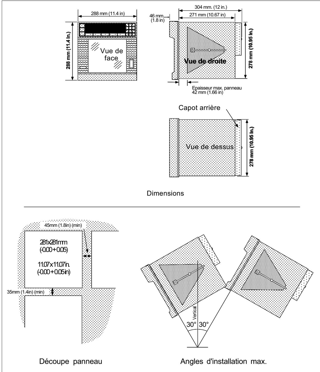
Figure 1.3 Installation mécanique
