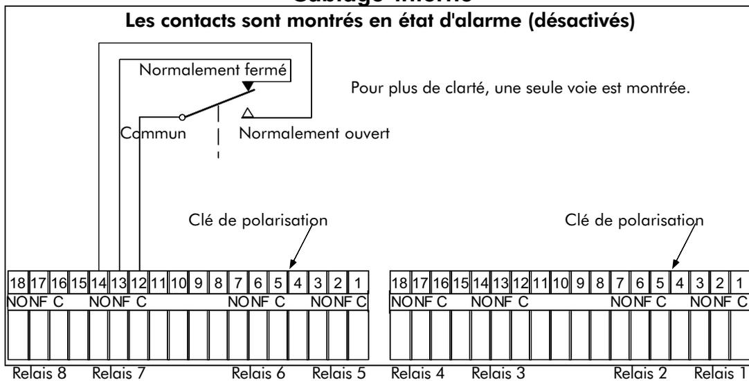
De façon à éviter toute erreur, des clés de repère sont insérées entre les bornes 4 et 5.
