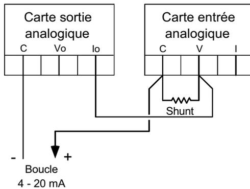
Figure 1.5.1 Câblage de la carte de retransmission en alimentation de capteur
