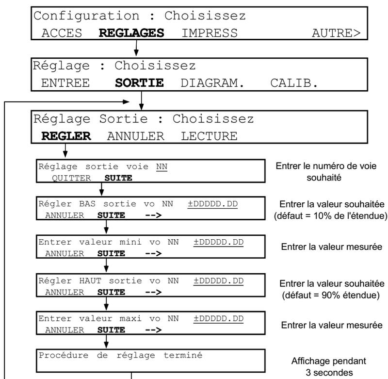
Figure 4.14.2 Menus de réglage de sortie analogique
