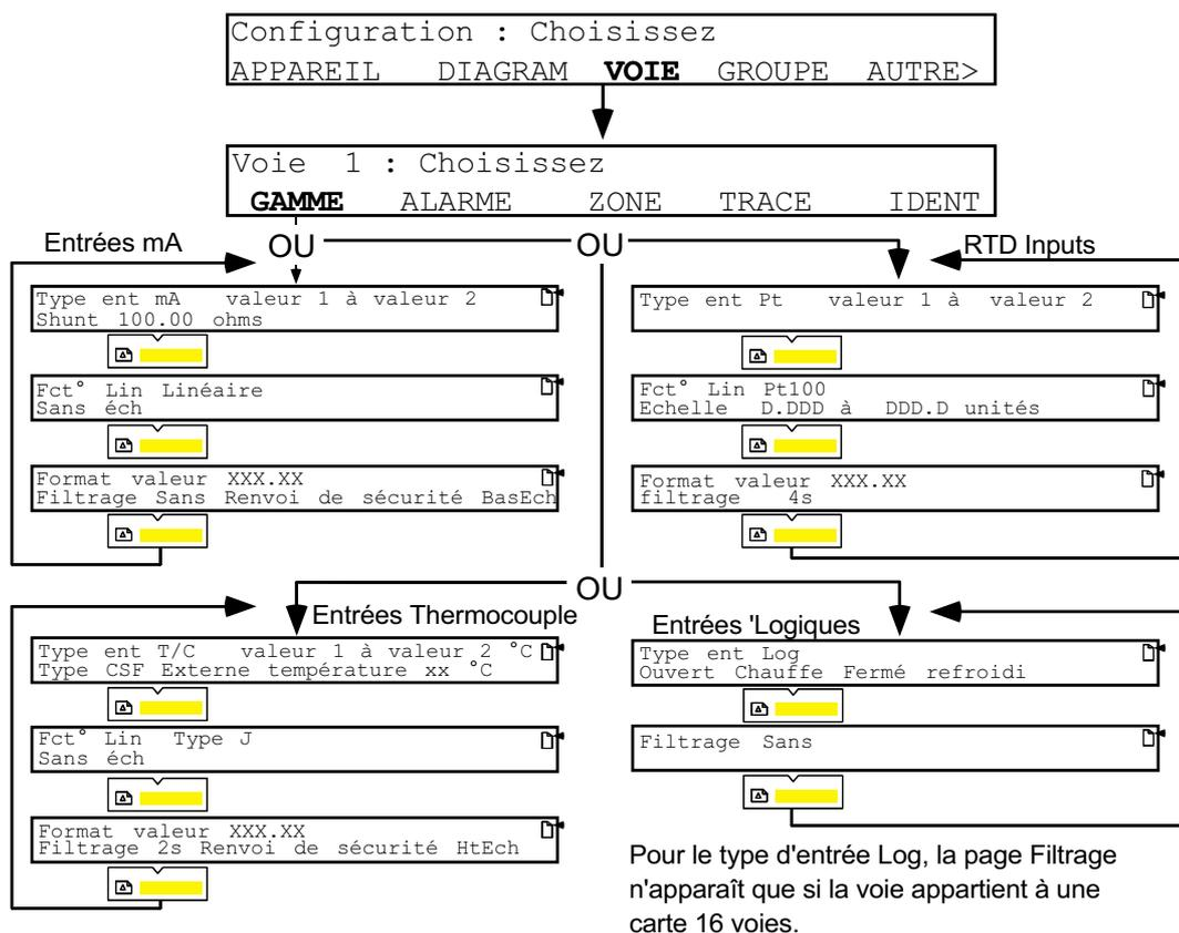
Figure 4.4.2a Configuration voies d'entrée: Pages typiques de gamme
