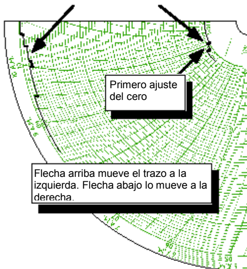
Fig. 3.10b Ajuste de cero y span (ejemplo sobre gráfico simulado)
