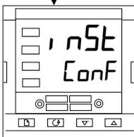
(Si un code d'accès incorrect a été saisi et si le régulateur est toujours 'verrouillé', l'appui sur *Défilement* à ce moment fait passer à l'affichage 'Err' avec 'nc' sur la ligne inférieure. Il suffit d'appuyer sur *Défilement* pour revenir à l'affichage 'CONF').
