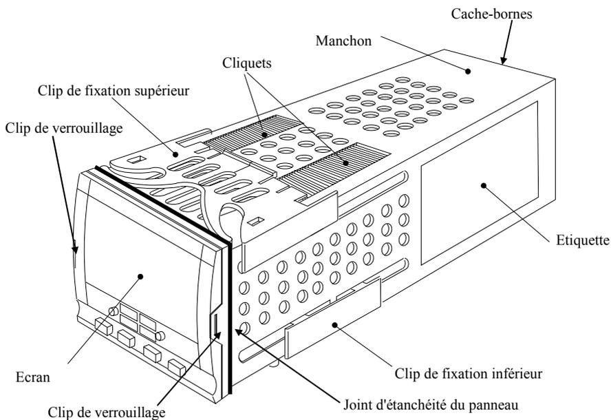
Figure 1-1 Régulateur 2416 1/16 DIN
