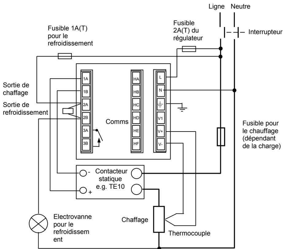
Fig 1-7 Schéma de câblage type pour régulateur 2416
