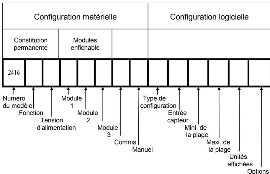
Il est possible de spécifier uniquement la configuration matérielle ou bien la configuration matérielle plus la configuration logicielle. **Pour spécifier uniquement le matériel**, il faut remplir uniquement la partie 1 du code de commande. **Pour spécifier à la fois le matériel et le logiciel**, il faut remplir les parties 1 et 2. Toutes ces configurations peuvent être effectuées sur site.
