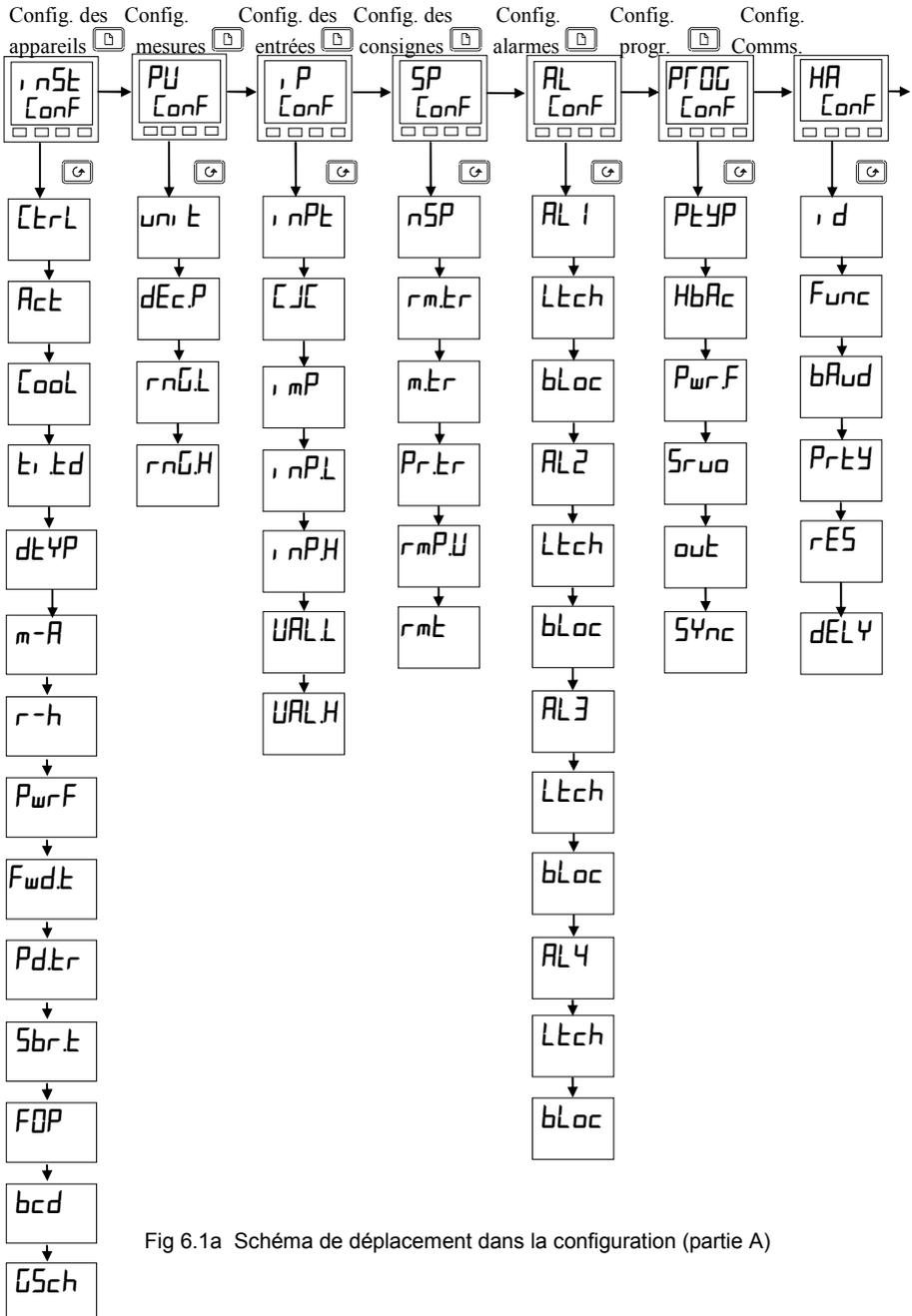
Fig 6.1a Schéma de déplacement dans la configuration (partie A)
