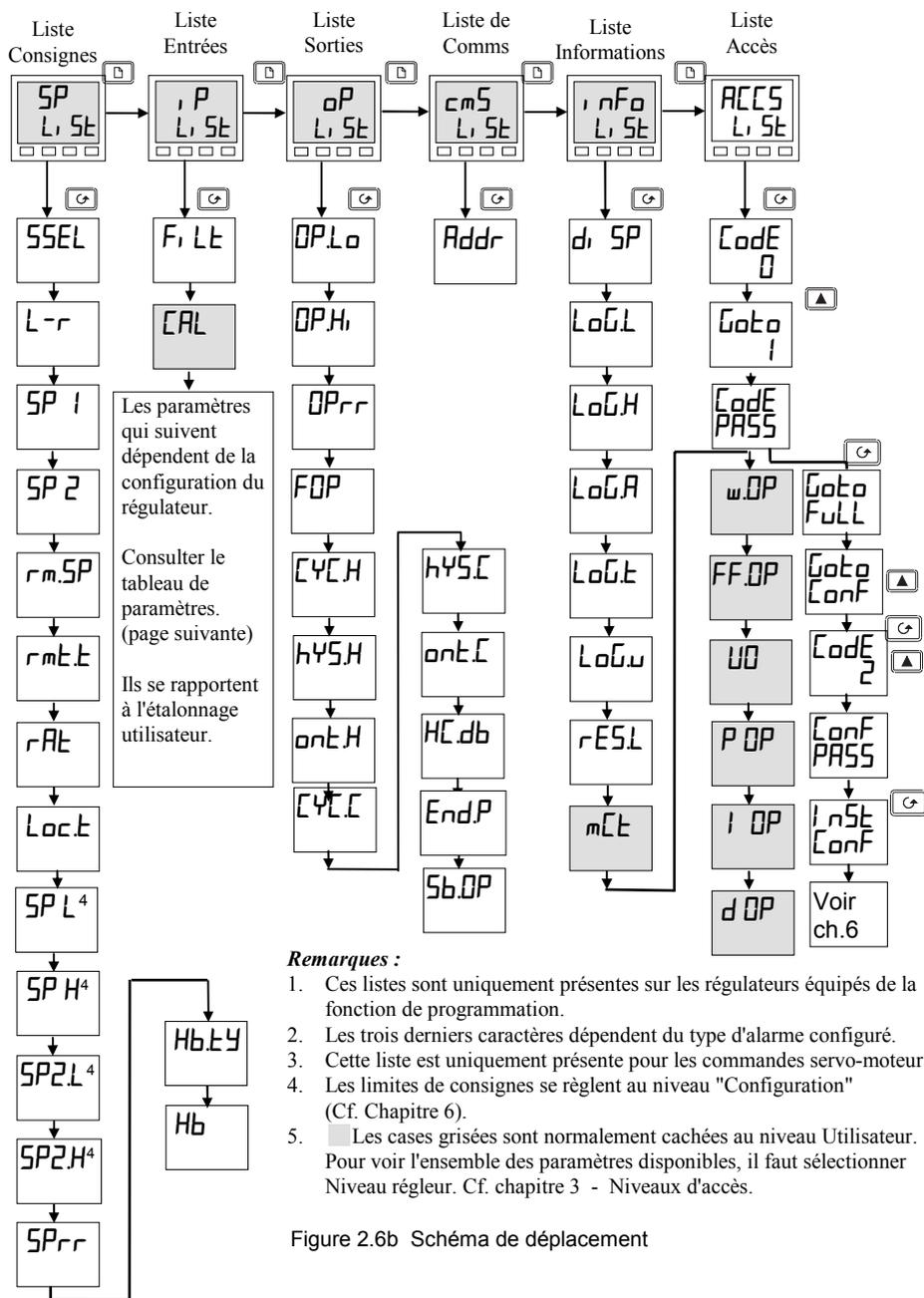
Figure 2.6b Schéma de déplacement
