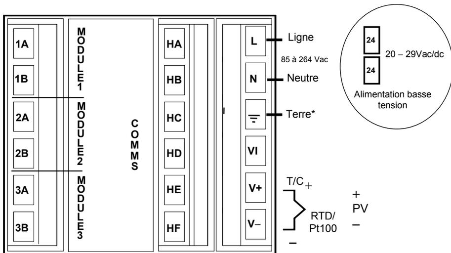
Figure 1-4 Disposition des bornes arrières
