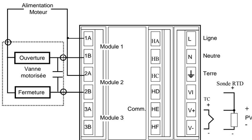
Figure 1-8 Branchements de vannes motorisées
