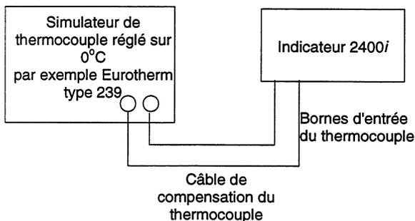
Procédure de calibration de la compensation de soudure froide
