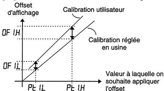
Il est possible de répéter la procédure qui précède pour l'entrée 2 à l'aide des paramètres *PE.2L*, *OF.2L*, *PE.2H*, *OF.2H*
