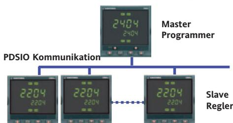
Mit PDSIO läßt sich ein Sollwertprofil zu mehreren Slave-Regler digital übertragen. Dies bietet eine ökonomische Lösung für z. B. eine Mehrzonenregelung.
