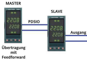
Mit der Eurotherm Sollwert Übertragung über PDSIO Kommunikation ist es möglich, zwei Regler der Serie 2400 als Kaskadenregler zu verwenden. Der Ausgang von Regler 1 (Master) gibt dem 2. Regler den Sollwert vor (Slave).
