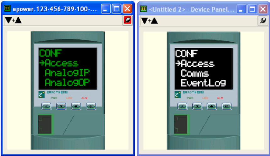
图 140 设备面板显示：在线 （左）与克隆 （右）。
