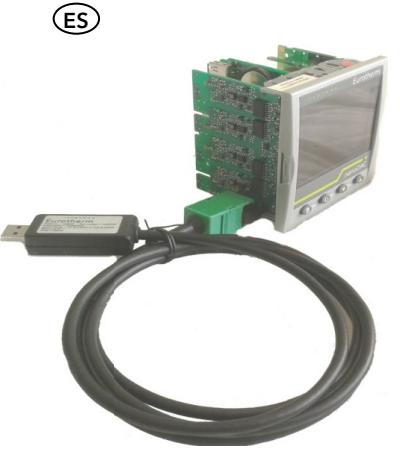
El clip CPI emula el puerto serie de un ordenador y está diseñado para conectarse el lateral de un regulador o indicador Eurotherm, como se muestra.
