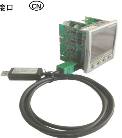
USB控制器编程接口模仿计算机的串行接口，插入Eurotherm控制器或指示器（如图所示）即可使用。
