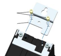
벌크헤드 장착 시, 'B' 나사와 연관된 흔들림 방지 와셔를 제거한 후 브래킷을 장치에 끼워넣은 다음 'B' 나사를 이용하여 체결하여 상단 브래킷 'A'를 장치의 후면에 설치합니다. 체결 시 브래킷이 올바른 방향으로 되어 있어야 하고 (표시된 것처럼) 흔들림 방지 와셔가 나사 헤드와 브래킷 사이에 끼워져 있어야 합니다.
