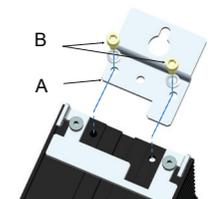
벌크헤드 장착 시, 'B' 나사와 연관된 흔들림 방지 와셔를 제거한 후 브래킷을 장치에 끼워넣은 다음 'B' 나사를 이용하여 체결하여 상단 브래킷 'A'를 장치의 후면에 설치합니다. 체결 시 브래킷이 올바른 방향으로 되어 있어야 하고 (표시된 것처럼) 흔들림 방지 와셔가 나사 헤드와 브래킷 사이에 끼워져 있어야 합니다. 연관된 스크루 드라이버에는 3mm AF 6각형 비트가 있어야 합니다. 권장된 체결 토크는 1.5Nm (1.1 lb-ft)입니다.
